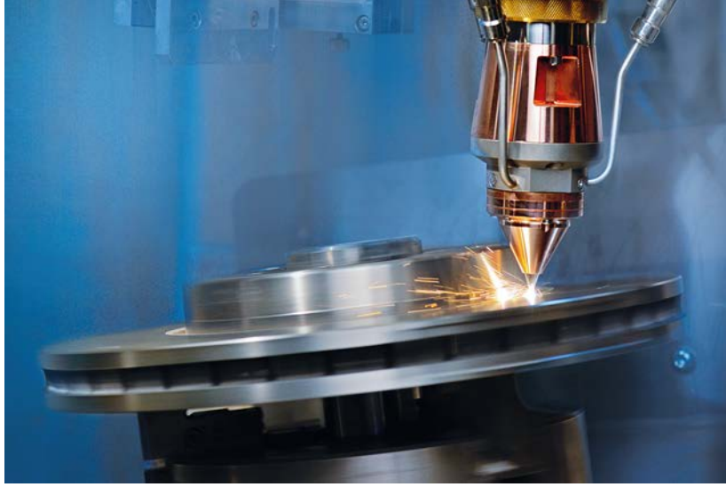
Resim 3: Bir fren diskinin EHLA kaplama süreci. © Fraunhofer ILT, Aachen.
